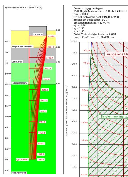
$\gamma_{(G,Q)} = 1.425$ Tiefenbeiwerte nach: IEG7 (SE) Gründungssohle = 0.25 m Grundwasser = 3.50 m Vorbelastung = 20.0 kN/m<sup>2</sup> Grenztiefe mit festem Wert von 5.75 m u. GS Grundbruch mit Tiefenbeiwerten Sohldruck Setzungen
